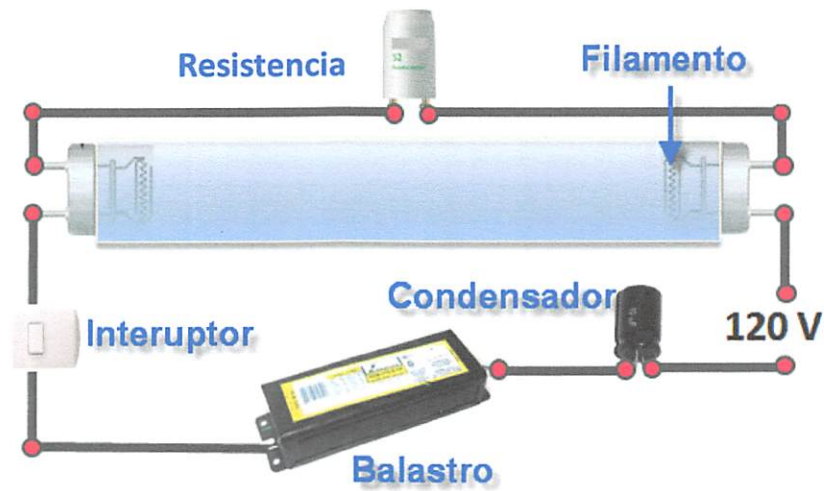
Figura 15. Partes de un tubo fluorescente
